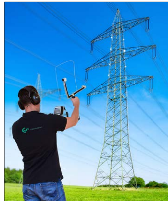
Kontroll av högspänningsledningningar avseende korona-urladdning
