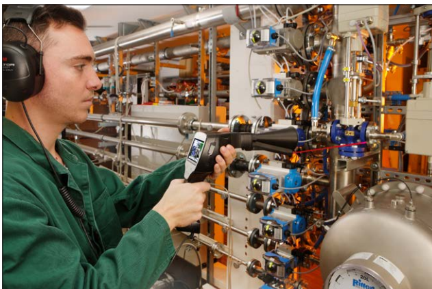
Med ljudisolerade hörlurar kan läckage även sökas i en extremt högljud omgivning. Omgivningsbuller dämpas, läckret (ej hörbart ultraljud) omvandlas till en hörbar signal. Med laser är en exakt lokalisering möjlig.
