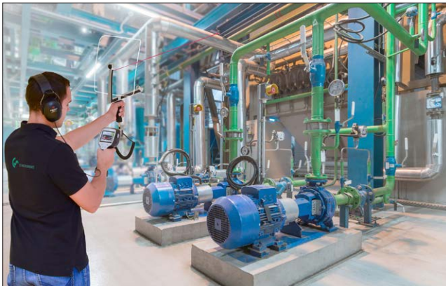
Exakt lokalisering av läckage under löpande drift med laserpekare och integrerad kamera
